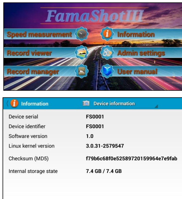
Slika 3. Prikaz ispisa kontrolnog broja na zaslonu kamere
